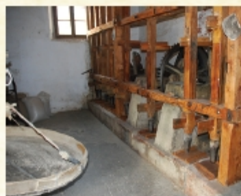
Interno della Pila con i Pestelli
